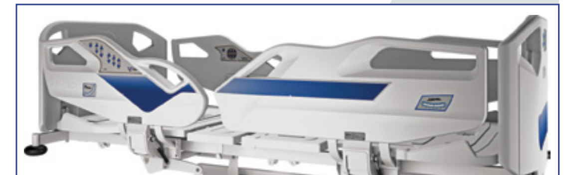
Conjunto Cabeceira/Peseira e Grades (cabeceira C-031 e grades G-021). Grades de proteção lateral articuláveis e retráteis em polietileno de alta densidade, prontas para a nova norma ABNT NBR IEC 60601-2-52:2013 que padroniza medidas de segurança para o paciente como: altura mínima das grades de 220 mm (acima do colchão) cobrindo mais de 50% do leito, espaçamentos menores de 60 mm entre as grades laterais e entre cabeceira/peseira e as grades laterais, aberturas embutidas nas grades/cabeceira/peseira menores que 120 mm e outros espaçamentos evitando aprisionamento de pescoço, tórax e cabeça. Possui mecanismo de destravamento e movimentação no sentido lateral da cama, injetados em liga de magnésio e ABS, permitindo o recolhimento para baixo do leito, facilitando a transferência do paciente e evitando problemas com pacientes sondados.
