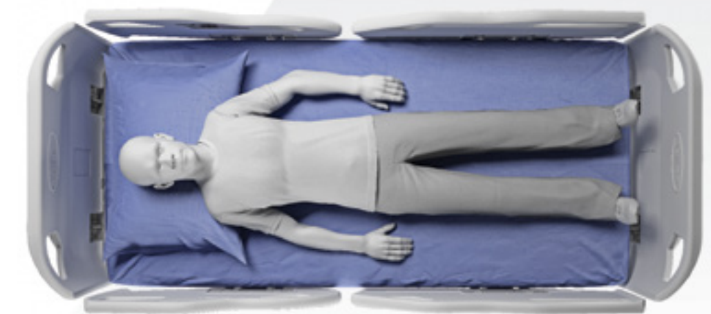
Conjunto Cabeceira/Peseira e Grades (cabeceira C-031 e grades G-021). Grades de proteção lateral articuláveis e retráteis em polietileno de alta densidade, prontas para a nova norma ABNT NBR IEC 60601-2-52:2013 que padroniza medidas de segurança para o paciente como: altura mínima das grades de 220 mm (acima do colchão) cobrindo mais de 50% do leito, espaçamentos menores de 60 mm entre as grades laterais e entre cabeceira/peseira e as grades laterais, aberturas embutidas nas grades/cabeceira/peseira menores que 120 mm e outros espaçamentos evitando aprisionamento de pescoço, tórax e cabeça. Possui mecanismo de destravamento e movimentação no sentido lateral da cama, injetados em liga de magnésio e ABS, permitindo o recolhimento para baixo do leito, facilitando a transferência do paciente e evitando problemas com pacientes sondados.
