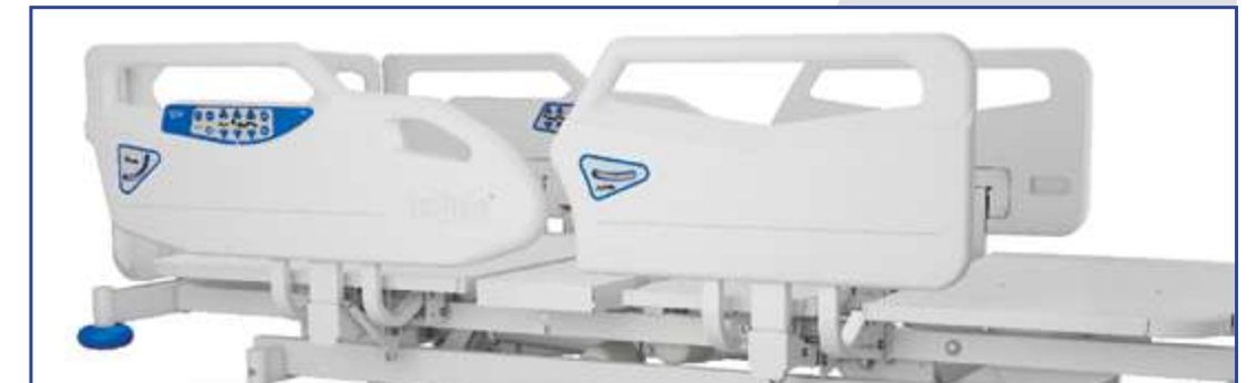
Conjunto Cabeceira/Peseira e Grades (cabeceira C-032 e grades G-023). Grades de proteção lateral articuláveis e retráteis em polietileno de alta densidade, certificadas pela nova norma ABNT NBR IEC 60601-2-52:2013 que padroniza medidas de segurança para o paciente como: altura mínima das grades de 220 mm (acima do colchão) cobrindo mais de 50% do leito, espaçamentos menores de 60 mm entre as grades laterais e entre cabeceira/peseira e as grades laterais, aberturas embutidas nas grades/cabeceira/peseira menores que 120 mm e outros espaçamentos evitando aprisionamento de pescoço, tórax e cabeça.
