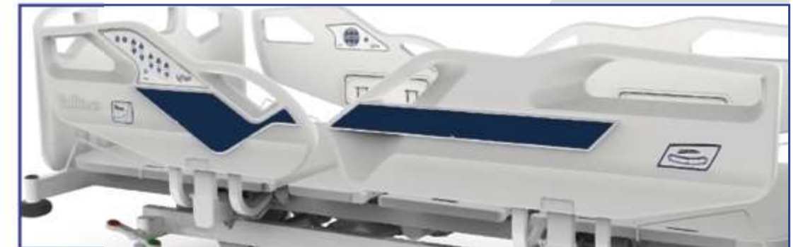
Conjunto Cabeceira/Peseira e Grades (cabeceira C-031 e grades G-021). Grades de proteção lateral articuláveis e retráteis em polietileno de alta densidade, certificadas pela nova norma ABNT NBR IEC 60601-2-52:2013 que padroniza medidas de segurança para o paciente como: altura mínima das grades de 220 mm (acima do colchão) cobrindo mais de 50% do leito, espaçamentos menores de 60 mm entre as grades laterais e entre cabeceira/peseira e as grades laterais, aberturas embutidas nas grades/cabeceira/peseira menores que 120 mm e outros espaçamentos evitando aprisionamento de pescoço, tórax e cabeça. Possui mecanismo de destravamento e movimentação no sentido lateral da cama, permitindo o recolhimento para baixo do leito, facilitando a transferência do paciente e evitando problemas com pacientes sondados.
