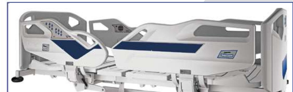
Conjunto Cabeceira/Peseira e Grades (cabeceira C-031 e grades G-021). Grades de proteção lateral articuláveis e retráteis em polietileno de alta densidade, certificadas pela nova norma ABNT NBR IEC 60601-2-52:2013 que padroniza medidas de segurança para o paciente como: altura mínima das grades de 220 mm (acima do colchão) cobrindo mais de 50% do leito, espaçamentos menores de 60 mm entre as grades laterais e entre cabeceira/peseira e as grades laterais, aberturas embutidas nas grades/cabeceira/peseira menores que 120 mm e outros espaçamentos evitando aprisionamento de pescoço, tórax e cabeça. Possui mecanismo de destravamento e movimentação no sentido lateral da cama, permitindo o recolhimento para baixo do leito, facilitando a transferência do paciente e evitando problemas com pacientes sondados.
