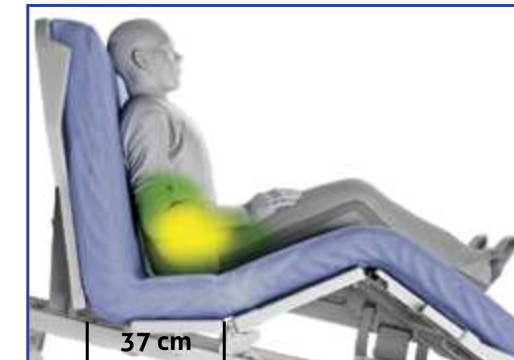
Sistema de compensação abdominal desenvolvido para reduzir a pressão no abdômen do paciente, onde uma compensação de 110 mm de deslocamento no dorso é realizada durante sua movimentação.
