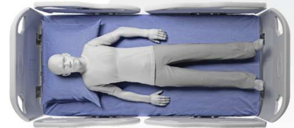
Conjunto Cabeceira/Peseira e Grades (cabeceira C-031 e grades G-021). Grades de proteção lateral articuláveis e retráteis em polietileno de alta densidade, certificadas pela nova norma ABNT NBR IEC 60601-2-52:2013 que padroniza medidas de segurança para o paciente como: altura mínima das grades de 220 mm (acima do colchão) cobrindo mais de 50% do leito, espaçamentos menores de 60 mm entre as grades laterais e entre cabeceira/peseira e as grades laterais, aberturas embutidas nas grades/cabeceira/peseira menores que 120 mm e outros espaçamentos evitando aprisionamento de pescoço, tórax e cabeça. Possui mecanismo de destravamento e movimentação no sentido lateral da cama, permitindo o recolhimento para baixo do leito, facilitando a transferência do paciente e evitando problemas com pacientes sondados.
