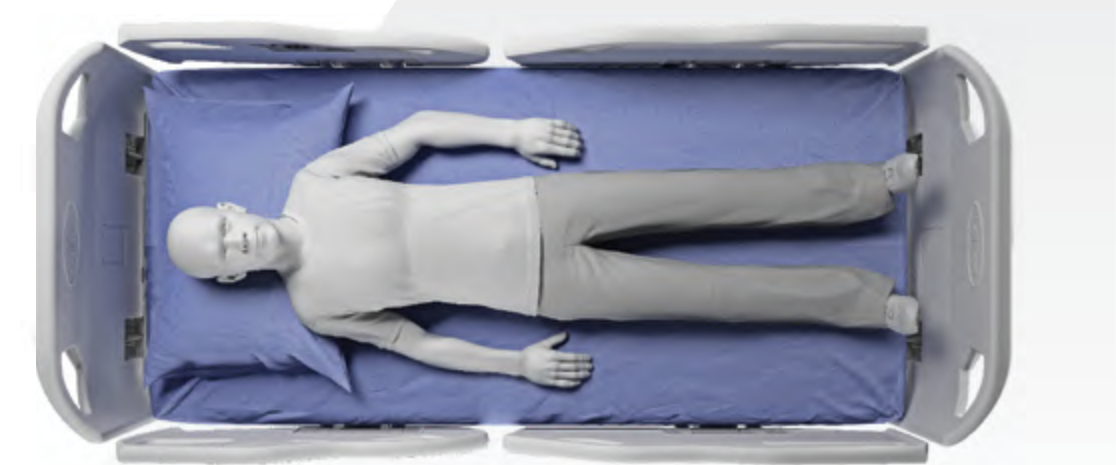
Conjunto Cabeceira/Peseira e Grades (cabeceira C-031 e grades G-021). Grades de proteção lateral articuláveis e retráteis em polietileno de alta densidade, certificadas pela nova norma ABNT NBR IEC 60601-2-52:2013 que padroniza medidas de segurança para o paciente como: altura mínima das grades de 220 mm (acima do colchão) cobrindo mais de 50% do leito, espaçamentos menores de 60 mm entre as grades laterais e entre cabeceira/peseira e as grades laterais, aberturas embutidas nas grades/cabeceira/peseira menores que 120 mm e outros espaçamentos evitando aprisionamento de pescoço, tórax e cabeça. Possui mecanismo de destravamento e movimentação no sentido lateral da cama, permitindo o recolhimento para baixo do leito, facilitando a transferência do paciente e evitando problemas com pacientes sondados.
