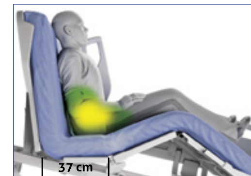
Sistema de compensação abdominal desenvolvido para reduzir a pressão no abdômen do paciente, onde uma compensação de 110 mm de deslocamento no dorso é realizada durante sua movimentação. Sistema padrão para grades G-021.
