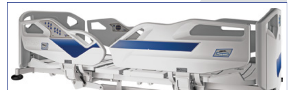
Conjunto Cabeceira/Peseira e Grades (cabeceira C-031 e grades G-021). Grades de proteção lateral articuláveis e retráteis em polietileno de alta densidade, certificadas pela nova norma ABNT NBR IEC 60601-2-52:2013 que padroniza medidas de segurança para o paciente como: altura mínima das grades de 220 mm (acima do colchão) cobrindo mais de 50% do leito, espaçamentos menores de 60 mm entre as grades laterais e entre cabeceira/peseira e as grades laterais, aberturas embutidas nas grades/cabeceira/peseira menores que 120 mm e outros espaçamentos evitando aprisionamento de pescoço, tórax e cabeça. Possui mecanismo de destravamento e movimentação no sentido lateral da cama, injetados em liga de magnésio e ABS, permitindo o recolhimento para baixo do leito, facilitando a transferência do paciente e evitando problemas com pacientes sondados.
