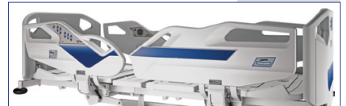
Conjunto Cabeceira/Peseira e Grades (cabeceira C-031 e grades G-021). Grades de proteção lateral articuláveis e retráteis em polietileno de alta densidade, certificadas pela nova norma ABNT NBR IEC 60601-2-52:2013 que padroniza medidas de segurança para o paciente como: altura mínima das grades de 220 mm (acima do colchão) cobrindo mais de 50% do leito, espaçamentos menores de 60 mm entre as grades laterais e entre cabeceira/peseira e as grades laterais, aberturas embutidas nas grades/cabeceira/peseira menores que 120 mm e outros espaçamentos evitando aprisionamento de pescoço, tórax e cabeça. Possui mecanismo de destravamento e movimentação no sentido lateral da cama, injetados em liga de magnésio e ABS, permitindo o recolhimento para baixo do leito, facilitando a transferência do paciente e evitando problemas com pacientes sondados.
