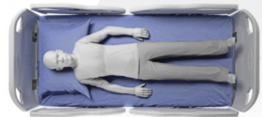
Conjunto Cabeceira/Peseira e Grades (cabeceira C-031 e grades G-021). Grades de proteção lateral articuláveis e retráteis em polietileno de alta densidade, certificadas pela nova norma ABNT NBR IEC 60601-2-52:2013 que padroniza medidas de segurança para o paciente como: altura mínima das grades de 220 mm (acima do colchão) cobrindo mais de 50% do leito, espaçamentos menores de 60 mm entre as grades laterais e entre cabeceira/peseira e as grades laterais, aberturas embutidas nas grades/cabeceira/peseira menores que 120 mm e outros espaçamentos evitando aprisionamento de pescoço, tórax e cabeça. Possui mecanismo de destravamento e movimentação no sentido lateral da cama, injetados em liga de magnésio e ABS, permitindo o recolhimento para baixo do leito, facilitando a transferência do paciente e evitando problemas com pacientes sondados.
